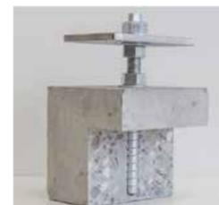
Le applicazioni possibili grazie al filetto metrico molto lungo sono numerose: **regolare la planarità** di una facciata architettonica fissandola a sbalzo sui solai, oppure **registrare la distanza** di un portapilastro da terra, **fissare i golfari** dei ponteggi alle colonne o ai solai in calcestruzzo.
