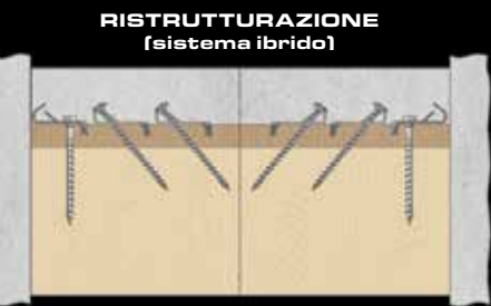
Applicazione in caso di ristrutturazione (con muri perimetrali esistenti)
